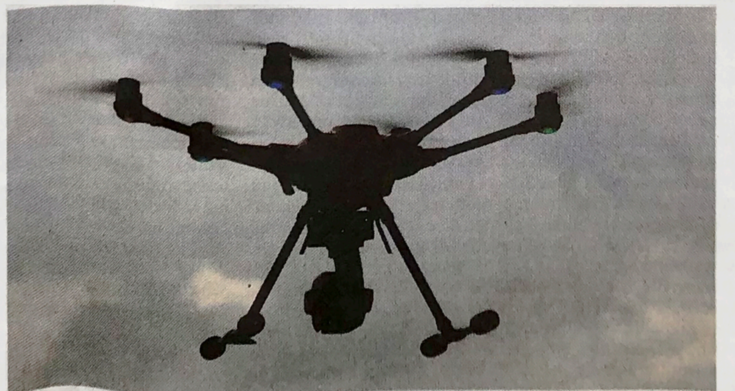
Die Drohne überfliegt jeden einzelnen Quadratmeter des Feldes, und die an ihr befestigte Kamera erkennt Temperaturabweichungen von zwei bis drei Grad sofort.
